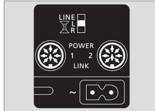
Das Anschlussfeld befindet sich an der Rückseite des Lautsprechers.
