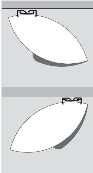
Mit der Platzierung der Halterung an der Rückseite des Lautsprechers wird der Winkel zwischen dem Lautsprecher und der Wand festgelegt.
