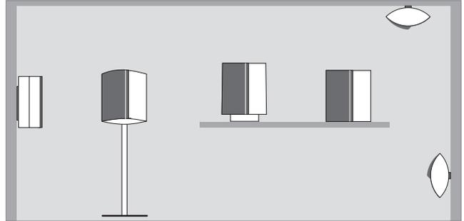
*Der Lautsprecher muss aufrecht auf seiner Basis platziert oder an der Wand oder Decke aufgehängt bzw. an einem optionalen Zubehör befestigt werden.*
