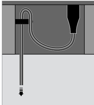
Befestigen Sie das Netzkabel aus Sicherheitsgründen hinter dem kleinen Stift, bevor Sie es aus dem Buchsenfach herausführen.
